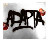
aerosoles y/o rotuladores) pues permite su limpieza con disolventes de uso habitual sin degradar el recubrimiento. Presenta una buena resistencia al exterior, así como una excelente resistencia química a los disolventes más habituales como el xileno, la acetona, el aguarrás y la metil etil cetona (MEK). Por otro lado, se ha homologado la Serie UB Antigraffiti en el laboratorio de materiales de la Agencia de Ensayos Ferroviarios de la SNCF según el método B de la norma francesa NF F 31-112.
